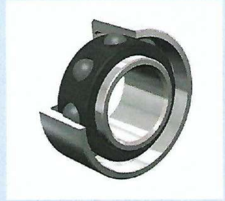
ตลับลูกปืนเม็ดกลมสัมผัสดเชิงมุม มีริงลูกปืนทำจาก Torlon® และแหวนนอกแบบมีฝักันฝุ่นรวมอยู่ในตัวตลับลูกปืน
