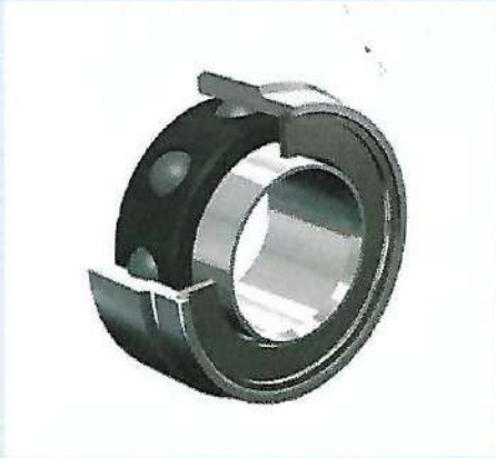
ตลับลูกปืนเม็ดกลมสัมผัสดเชิงมุม มีริงลูกปืน Torlon® และ แหวนนอกที่ทำเป็นชิ้น
