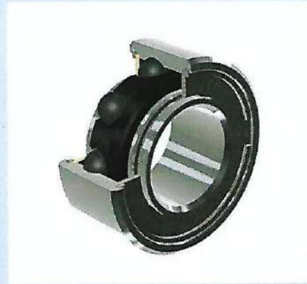
ตลับลูกปืนเม็ดกลมร่องลึก มีฝักันฝุ่นเคลือบทอง, มีร่องที่แหวนใน, รางวิ่งเยื้องแนว และริงแบบมงกุฎทำจาก Torlon®
